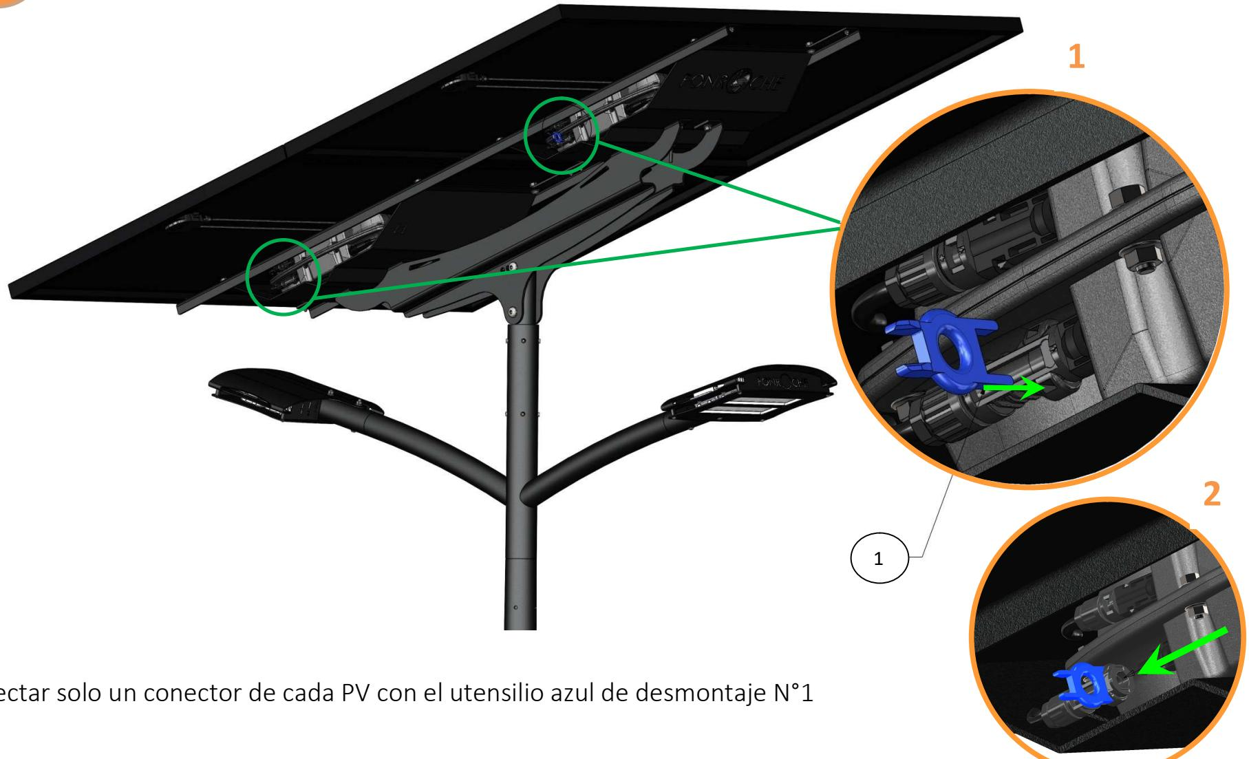
Desconectar solo un conector de cada PV con el utensilio azul de desmontaje N°1
