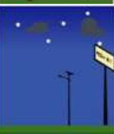
El PV **no debe estar sujeto a una iluminación artificial** durante la noche. La contaminación lumínica podría producir un voltaje al PV (> 0V) y entonces apagar la luz.
