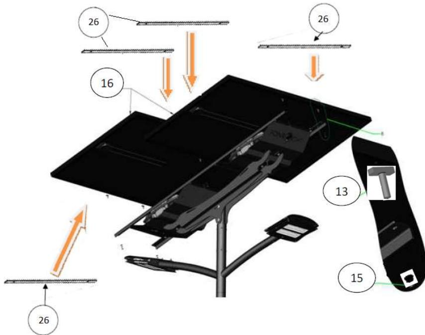
Les plats renforts n° 26 (en option, uniquement sur CSA grand vent) sont à positionner à l'intérieur du cadre du PV et à fixer avec les vis/écrous 13 et 15.
