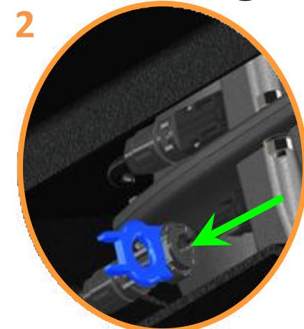
Desconectar solo un conector del PV con el utensilio azul de desmontaje N°1
