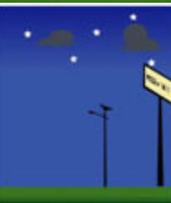
Le PV ne doit pas être soumis à un éclairage artificiel pendant la nuit. La pollution lumineuse pourrait engendrer une tension aux bornes du PV (tension PV > 0V) et donc éteindre la lumière.
