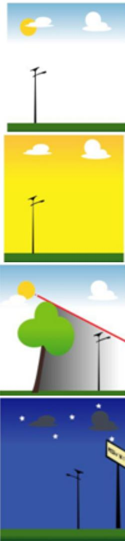
La batería se carga durante el día gracias a la electricidad producida por el módulo fotovoltaico (PV).
