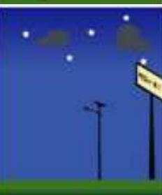
Le PV **ne doit pas être soumis à un éclairage artificiel** pendant la nuit. La pollution lumineuse pourrait engendrer une tension aux bornes du PV (tension PV > 0V) et donc éteindre la lumière.
