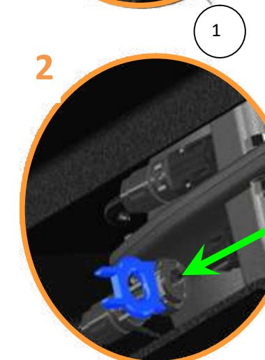
Détacher seulement un connecteur du PV à l'aide de l'outil de démontage n°1.
